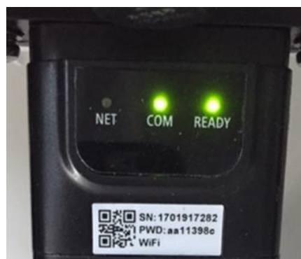
Figure 127 – État de communication irrégulière entre carte et serveur à distance
