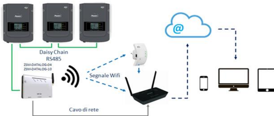
Figure 128 – Schéma de connexion du datalogger ZSM-DATALOG-04 / ZSM-DATALOG-10
