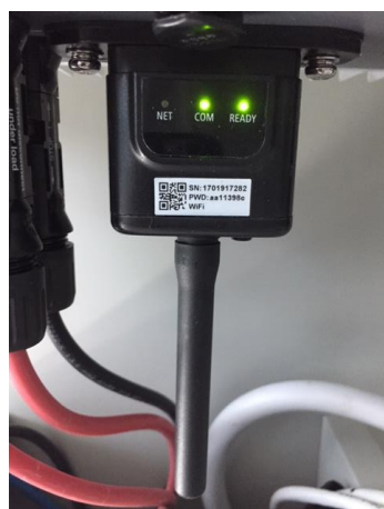
Figure 106 – État initial des led
