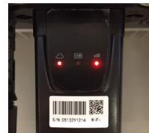
Figure 109 – État de communication irrégulière entre onduleur et Wi-Fi
