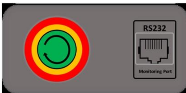
Figure 69 – Vue du bouton d'allumage de la batterie WeCo
