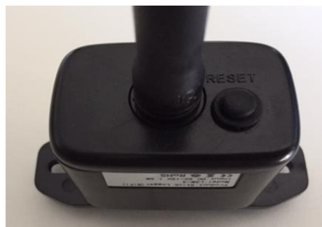
Figure 108 – Touche de réinitialisation sur la carte Wi-Fi
