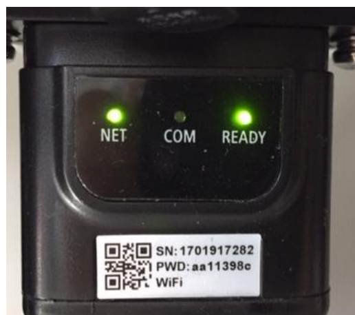
Figure 120 – État de communication irrégulière entre onduleur et carte
