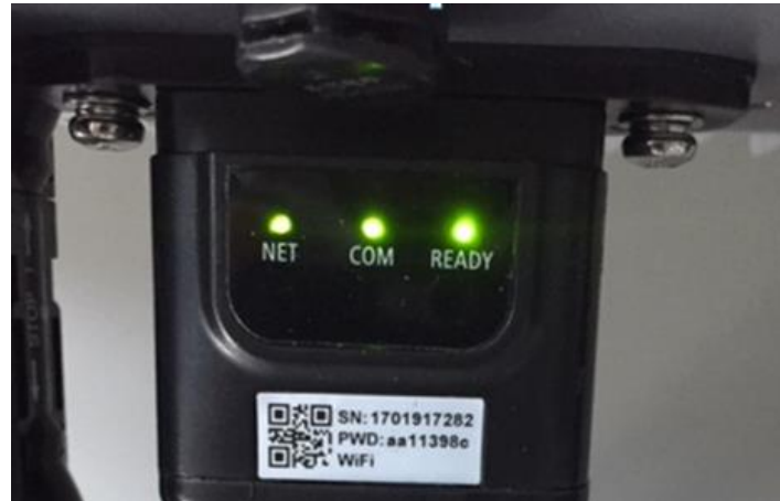
Figure 119 – État final des led
