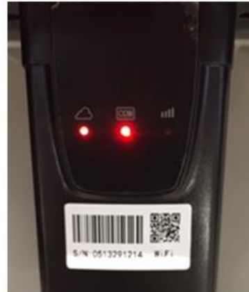
Figure 107 – État final des led
