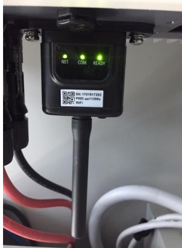
Figure 107 – État final des led
