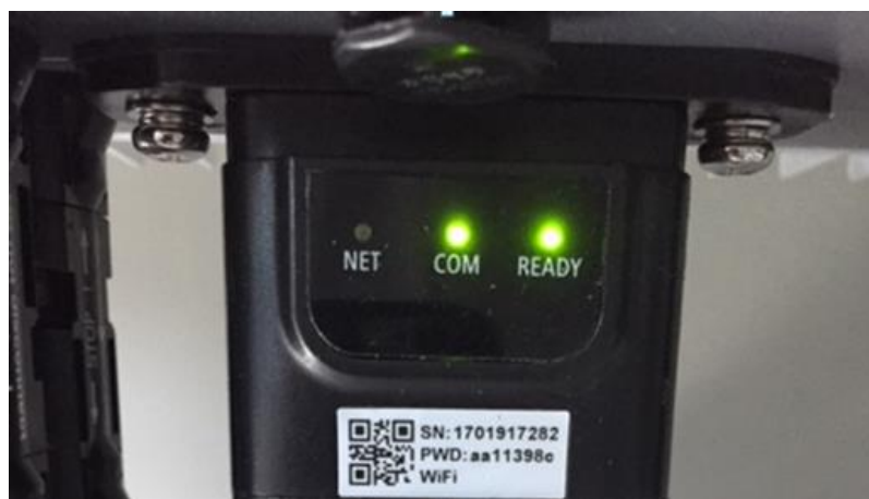
Figure 118 – État initial des led
