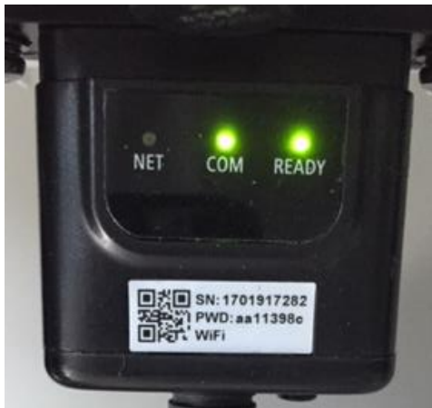
Figure 111 - État de communication irrégulière entre Wi-Fi et serveur à distance
