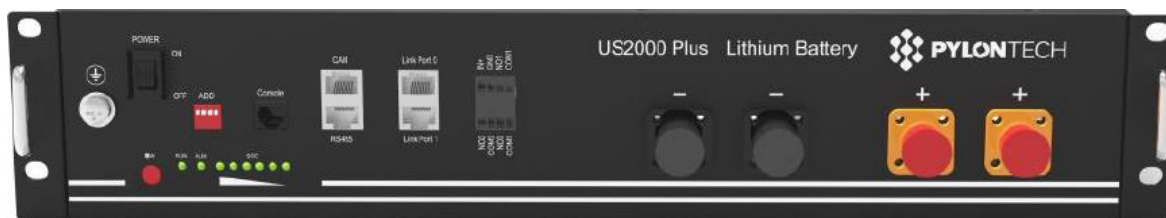
Figure 67 – État de la batterie après avoir positionné le commutateur POWER sur ON et appuyé sur le bouton SW
